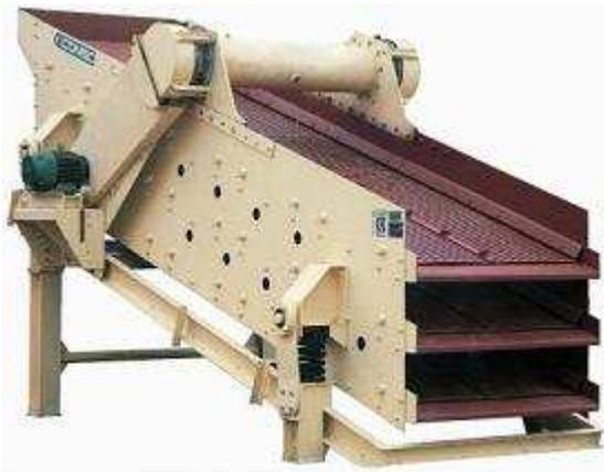
Fig. 3.6 - Vaglio vibrante a secco (a 3 piani)
