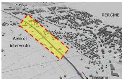
L'U.O. ha fornito il proprio supporto tecnico al Servizio Gestione strade per la progettazione acustica di una barriera antirumore integrata con pannelli fotovoltaici a protezione di una serie di edifici siti nel comune di Pergine Valsugana. La particolarità di questa barriera è individuabile nel fatto che l'opera sarà realizzata anche
