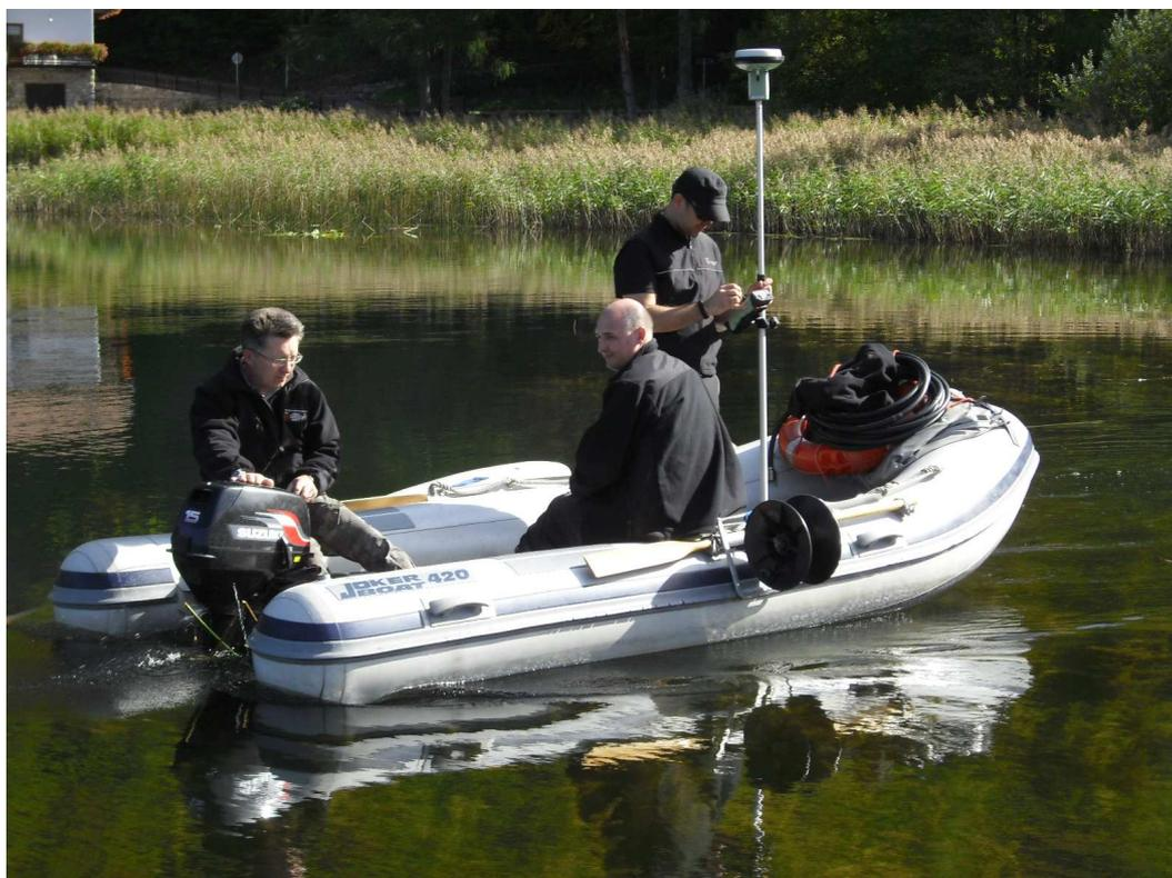
Fig. 2. Georeferenziazione del perimetro interno del canneto
