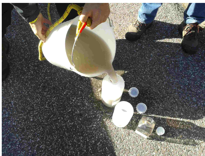
Fig. 10: Raccolta di un campione istantaneo
