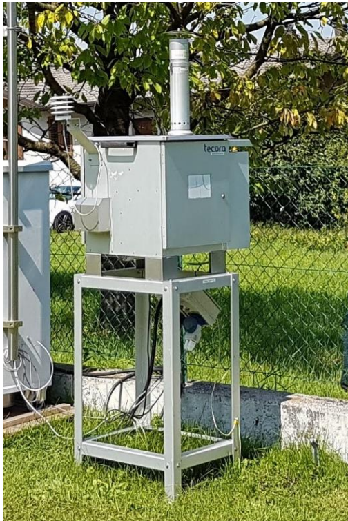
Figura 11: particolare del posizionamento del campionatore di polveri sottili PM10 nel giardino del civico 25 della S.P. 133dir Monterovere
