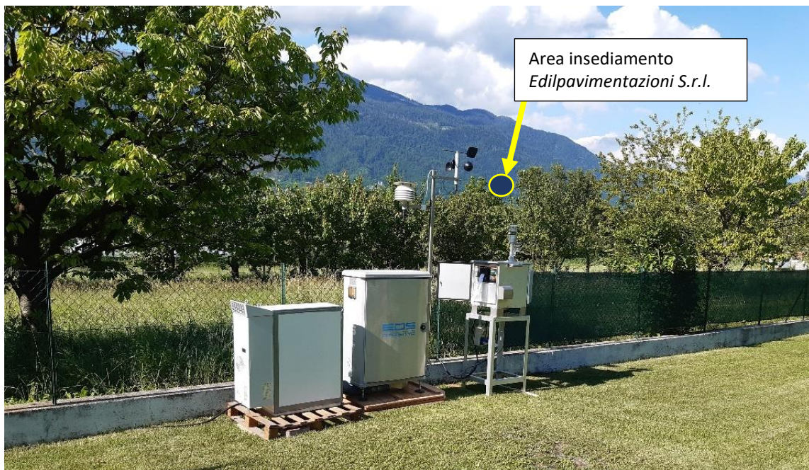
Figura 5: particolare del posizionamento del naso elettronico e del campionario di polveri sottili PM10 nel giardino del civico 25 della S.P. 133dir Monterovere
