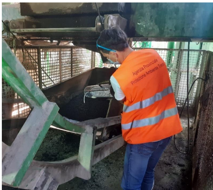
Figura 8: campionamento emissione asfalto a caldo - 1
