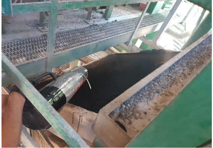
Figura 8: campionamento emissione asfalto a caldo - 2
