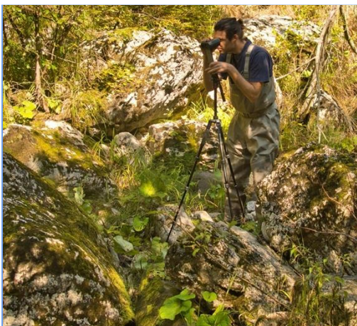
Figura 7: Esempio di delimitazione delle unità idro-morfologiche (UMI) attraverso l'utilizzo di un telemetro laser Trupulse 360R in comunicazione con un computer palmare PDA (Getac PS336).
