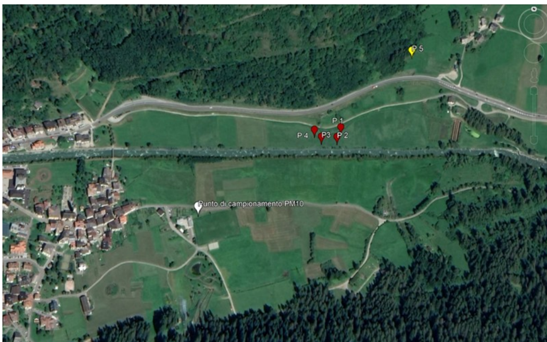
Fig. 2.1: Localizzazione dei siti di campionamento (in bianco il campionamento delle polveri PM10, in rosso il campionamento della bonifica ed in giallo il campionamento di terreno naturale)
