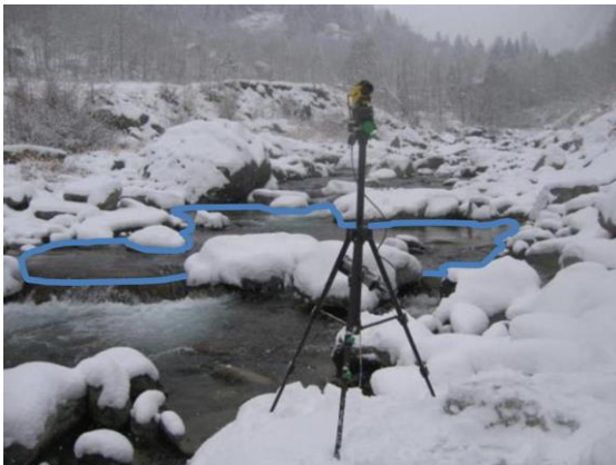
Figura 2 Esempio di delimitazione delle unità idro-morfologiche (UMI) attraverso l'utilizzo di un telemetro laser Trupulse 360R in comunicazione con un computer palmare PDA (Getac PS336).
