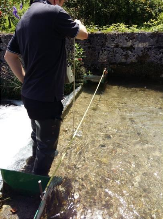
Figura 41: rio Vela. Sezione in corrispondenza della quale sono state effettuate le misure di velocità per il calcolo della portata.
