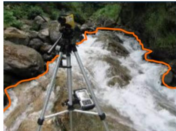
Figura 2 Esempio di delimitazione delle unità idro-morfologiche (UMI) attraverso l'utilizzo di un telemetro laser Trupulse 360R in comunicazione con un computer palmare PDA (Getac PS336).
