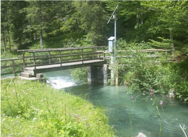
Figura 34: Torrente Sarca di Nambrone. Sezione in corrispondenza della quale si localizza la stazione idrometrica e in cui sono state effettuate le misure di velocità con il mulinello.
