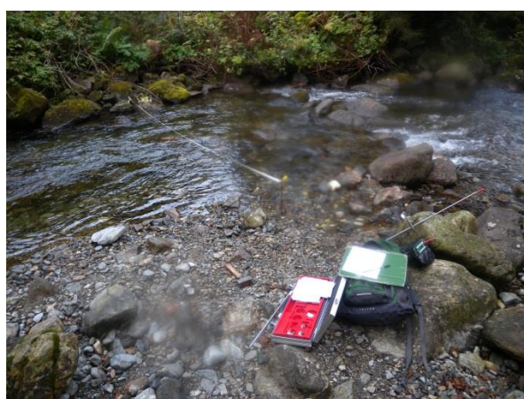
Figura 11: Sezione di misura della portata e tabella che indica data e risultato della misura.
