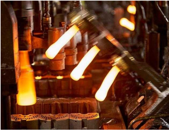
Abozzi in entrata allo stampo finitore
