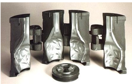
Alcune tipologie di stampi per vetro cavo
