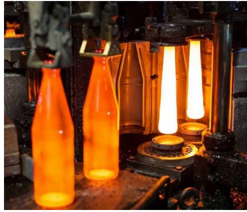
Abozzi posizionati nello stampo finitore
