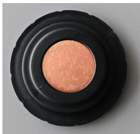
Elettrete utilizzato per le misure di radon, è visibile il disco di Teflon caricato elettrostaticamente in grado di raccogliere gli ioni prodotti dal decadimento del radon e dei suoi figli.
