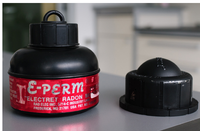
I dosimetri completi (elettrete e camera di plastica conduttiva) come si presentano per le misure di radon indoor; a sinistra per misure brevi (qualche settimana), a destra per misure lunghe (fino a un anno).
