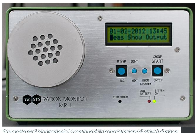
Strumento per il monitoraggio in continuo della concentrazione di attività di radon
