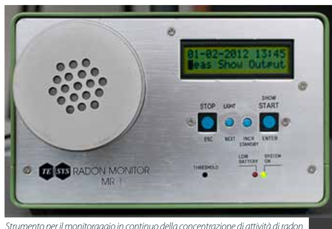
Strumento per il monitoraggio in continuo della concentrazione di attività di radon
